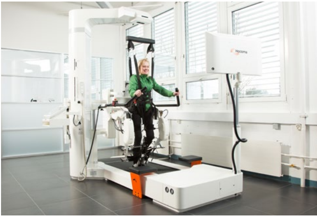
FIGURA 1. Ejemplos de robots aplicados a la neurorrehabilitación. Izquierda: Lokomat®, robot para uso terapéutico rehabilitador del miembro inferior. Derecha: Armeo®Spring, robot para uso terapéutico rehabilitador del miembro superior. Con permiso de Hocoma AG®.
